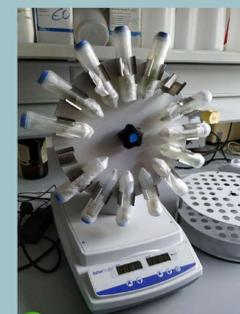
Figura 4. Muestras en agitador rotativo para tubos Fisherbrand
